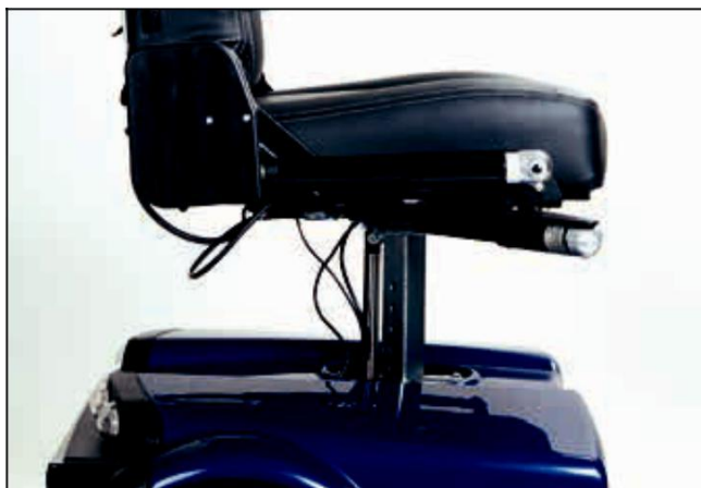
Elektrický sedadlový sloup, kompletní, 15 cm zdvih sedadla pro sedadlový systém ERGO2. M-127-02-051
