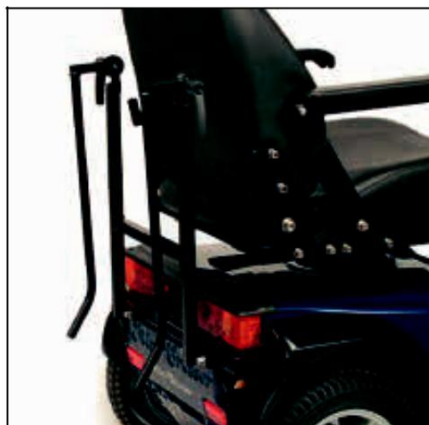
Držák na manuální vozík, zadní, max. váha 20 kg (44lb). T-127-06-131.
