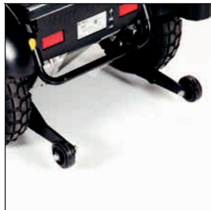
Stabilizační kolečka, u některých modelů jsou standardní součástí výbavy M-127-06-104
